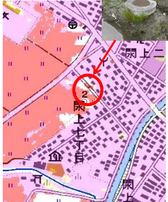
図6 「震災記憶地図」で 表示した標高メッシュ区分地図 三角点では標高2m だが、震災後測量した標 高メッシュでは0m 未満であり、地盤沈下が 起こったことが想定される。
