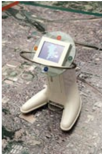
図4 ころっとシステム（岡山市デジタルミュージアム）7000個のICタグが床に埋め込まれ、空中写真を機械でのぞくと映像が出る。
